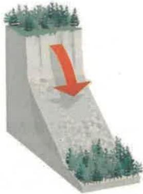
L'évolution des massifs rocheux et leurs fronts engendre des phénomènes d'instabilité se traduisant par des effondrements de volumes variables. Il s'agit de déplacements de masses, rapides et discontinus, pouvant être d'origines naturelle ou anthropique.
